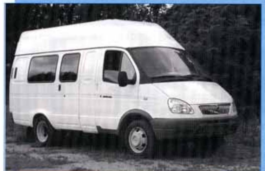
**Фото 4. Мобильная станция АРГУМЕНТ с радиопеленгатором АРТИКУЛ-М с антенной системой АС-МП6**
