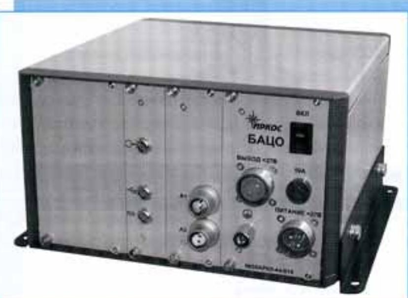
**Фото 2. Блок аналого-цифровой обработки пеленгатора**
