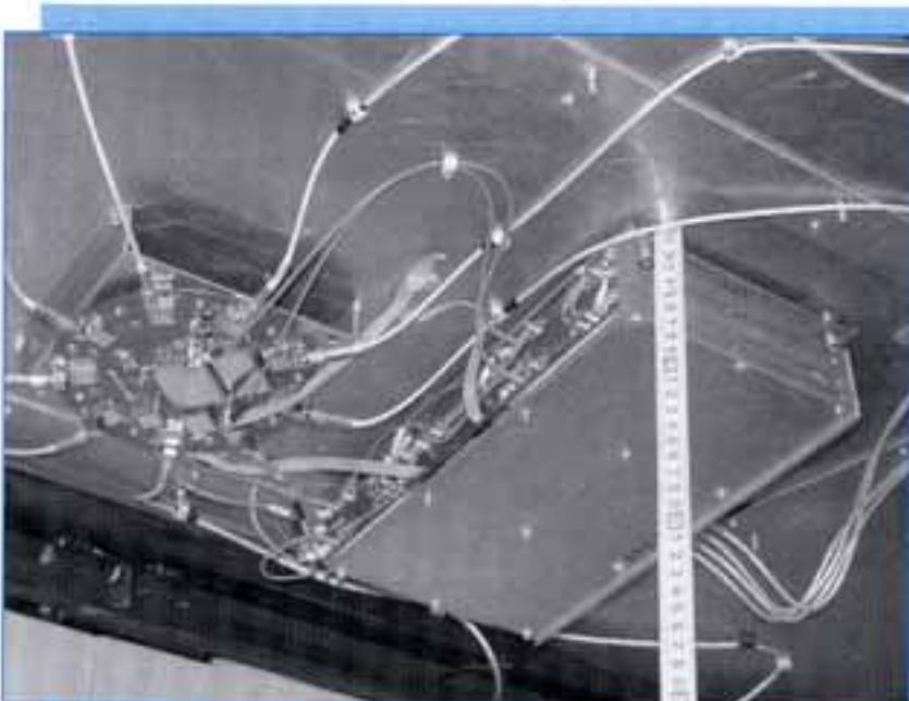
**Фото 5. Размещение двухканального преобразователя и антенного коммутатора под потолочной обшивкой станции АРГУМЕНТ**
