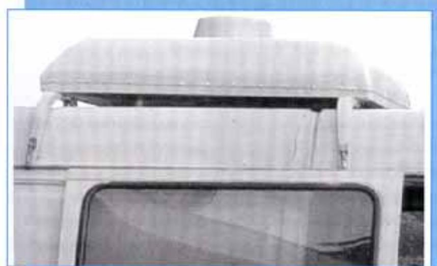
**Фото 3. Антенная система АС-МП1 радиопеленгатора АРТИКУЛ-М, установленная на крыше автомобиля**
