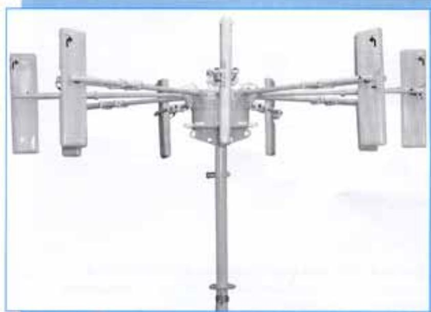
**Фото 9. Антenna система пеленгатора АРТИКУЛ-П в развернутом состоянии**
