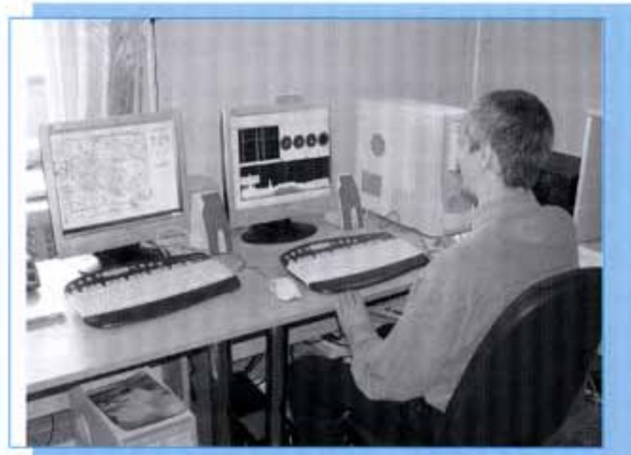
**Фото 16. Центральная станция АРЧА. Пост радиомониторинга, пеленгования и местоопределения источников радиоизлучения**
