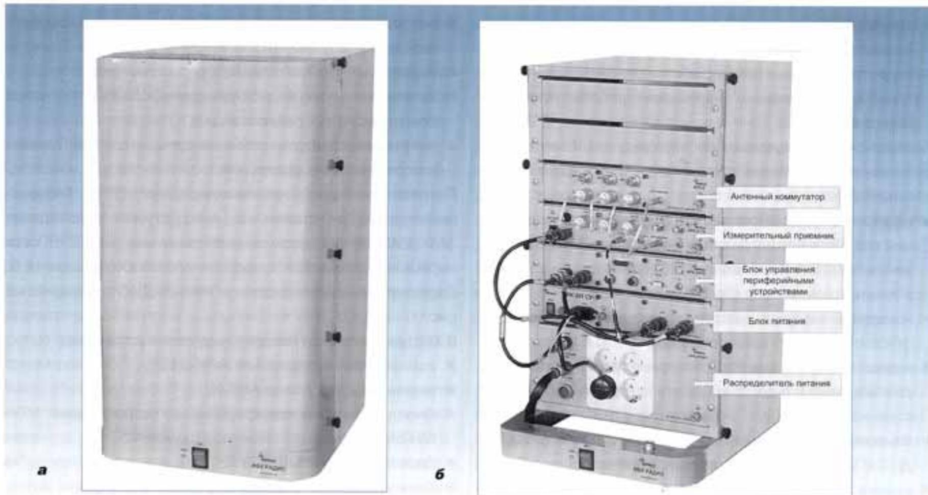
**Фото 1. Внешний вид стойки радиооборудования с закрытой (а) и открытой (б) крышкой**
